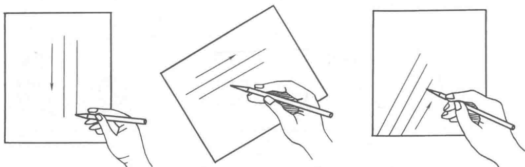
图 1-18 徒手画直线、斜线的方法
