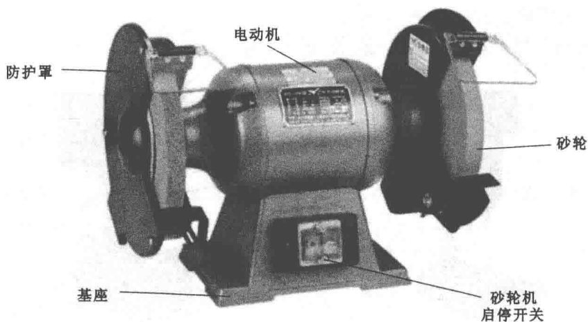
图 1-2-4 砂轮机的结构
