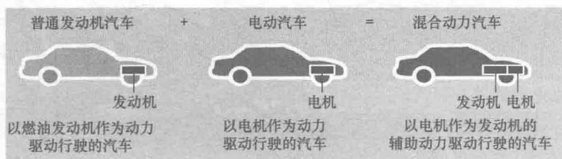
图 1-3 混合动力电动汽车的基本概念
