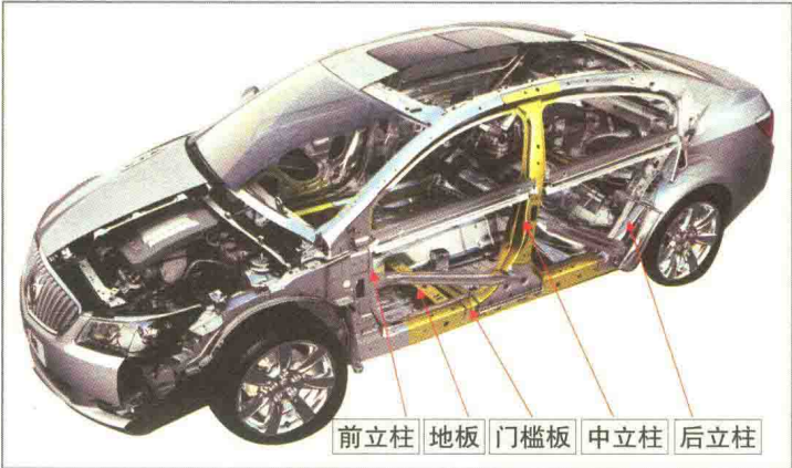
图 1-7 立柱 / 门槛板 / 地板位置及车身加强件示意图
