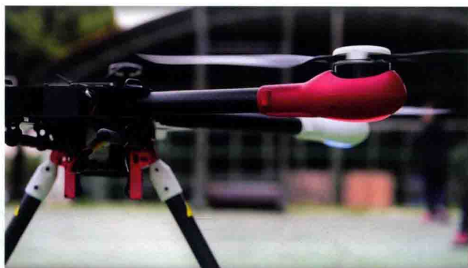
• 右边红色的部分是航拍机的电机，电机上方是旋翼
