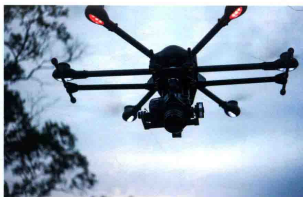
• 多旋翼的升力甚至可承载一台单反相机
