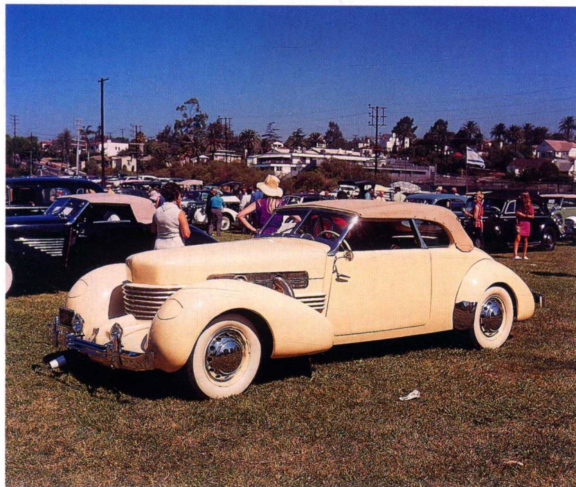
◀ 1937年的柯德（Cord）软顶敞篷车，表明流线型时代开始影响汽车造型。一些人认为这是史上最漂亮的汽车。浮筒状的挡泥板与车身融合在一起，散热器外壳和行李舱也融入车身造型中。与20世纪40年代之前量产的汽车不同，这辆车去掉了脚踏板。
