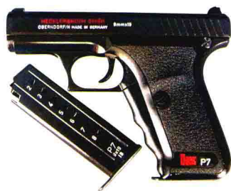
P7的退壳速度虽然较慢，但由于其上膛流畅、速度快，因而仍拥有较高的射速
