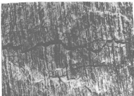
图2—9 全斜照明显示裂纹 \times 25
