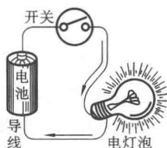
图 1-1 一个简单电路
