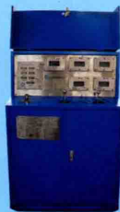
节流管汇控制台
