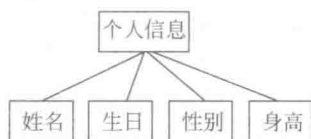
图 1-3 XML 文档树结构
