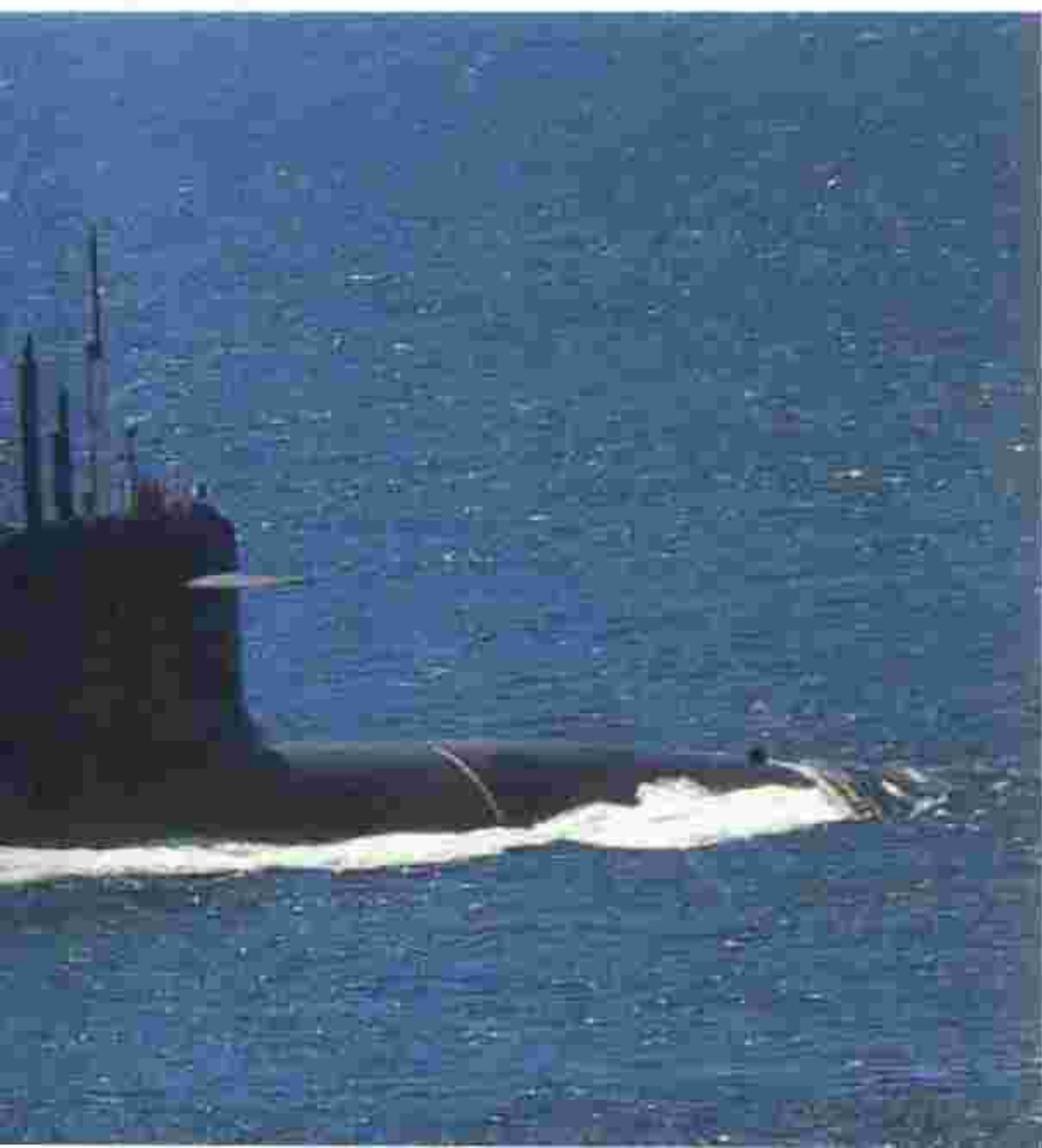
上图: 法国弹道导弹核潜艇的发展和苏联一样, 发展一型导弹配备一型潜艇。该级艇设置16具弹道导弹发射筒, 设计装备M-51导弹, 采用TN-75核弹头。该型导弹为三级固体燃料导弹, 射程11000千米。
