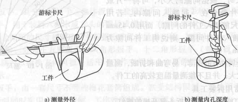
图 1-8 游标卡尺的使用方法
