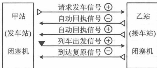
图 1.1.1 64D 半自动闭塞的正常办理步骤
