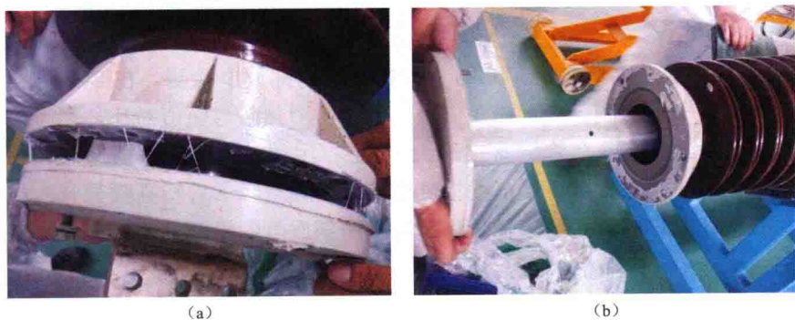
图 1-9 导电杆法兰与套管法兰对接面涂胶情况
