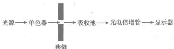
图 2-3 分光光度计结构
