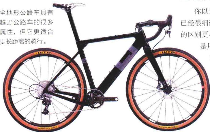
你以为越野公路车和普通的公路自行车之间的区别已经很细微了，实际上全地形公路车和越野公路车之间的区别更小。它们之间主要的区别是，全地形公路车不是用来竞赛的，而是为了能在各类混合地形中长时间骑行。全地形公路车一般设有挡泥板和货架的安装孔，车架的几何构造也更舒缓，使车手骑行时感觉更轻松舒适。全地形公路车能搭配更宽的轮胎，并且有着更大的挡位选择范围，很适合比较休闲的长距离骑行。
