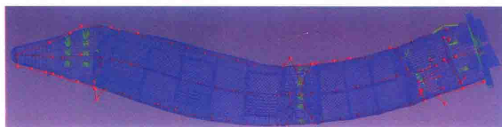
图 5-42 助推器 I-III 方向一阶弯曲模态修正结果 (P197)
