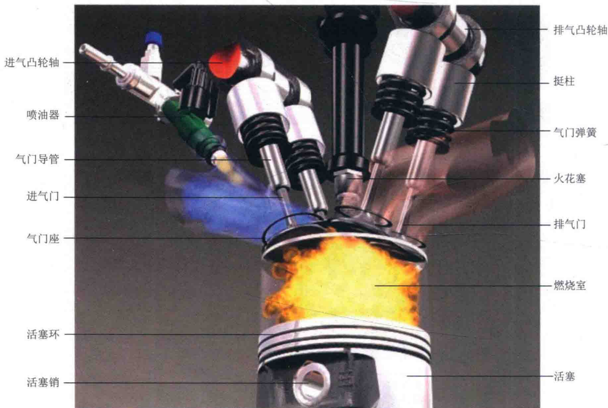
汽油在气缸内燃烧示意图
