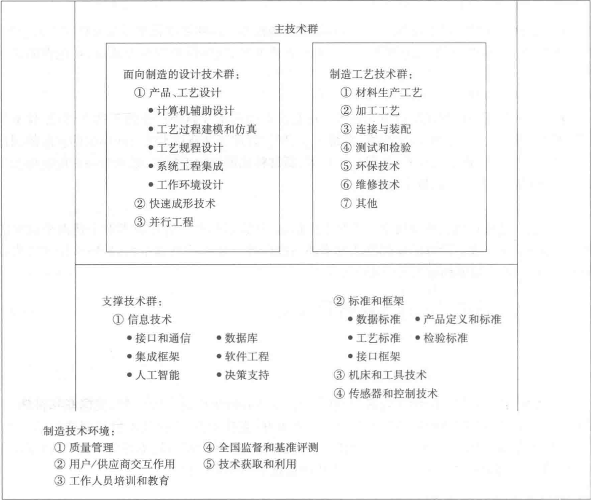
图 1-2 现代制造技术的体系结构
