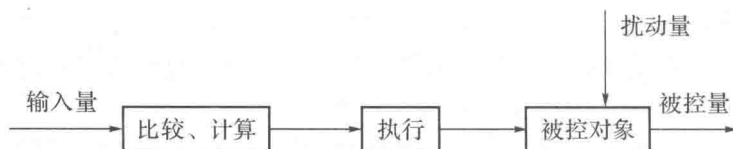
图 1-3 按输入量操纵的开环控制系统结构图
