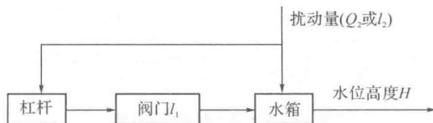
图 1-8 水箱水位高度控制系统结构图
