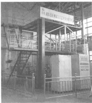
图5 300Nm 3 /d 燃煤烟气 CO 2 捕集连续测试模试装置
