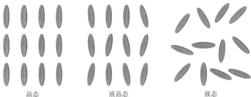
图 1-1 晶态、液晶态和液态中分子的排列
