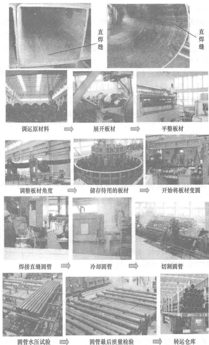
图 2-2 直缝焊管的生产工艺流程
