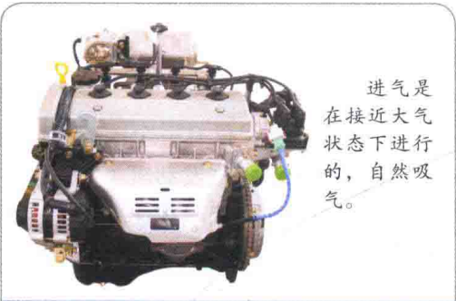
图 1-15 自然吸气（非增压）式发动机
