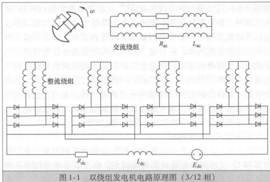
图 1-1 双绕组发电机电路原理图 (3/12 相)
