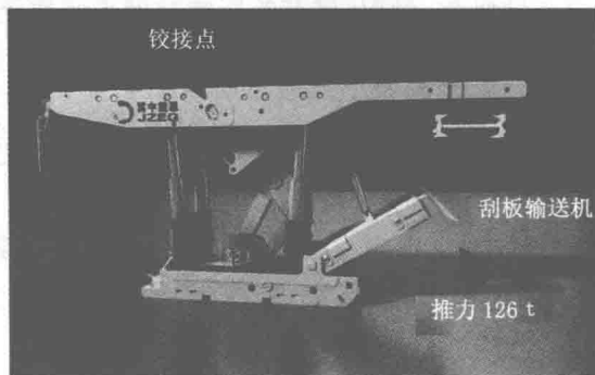
图3 充填采煤液压支架结构示意图
