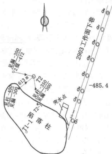
图1 “阻水墙”设计示意图
