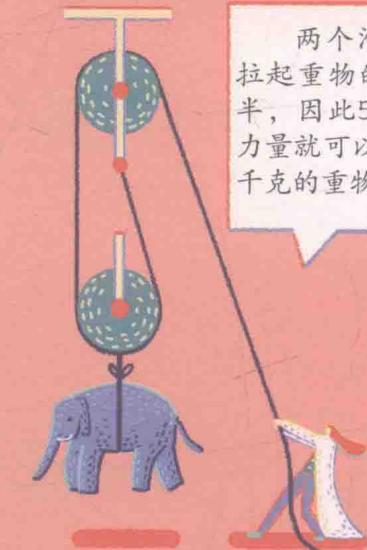
两个滑轮使得拉起重物的力量减半，因此50千克的力量就可以吊起100千克的重物。
