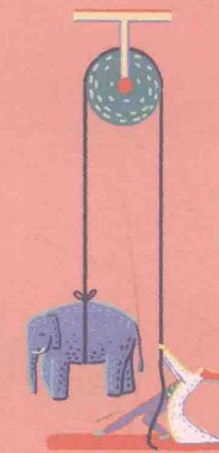
通过一个垂直的滑轮，100千克的力量可以吊起100千克的重物。
