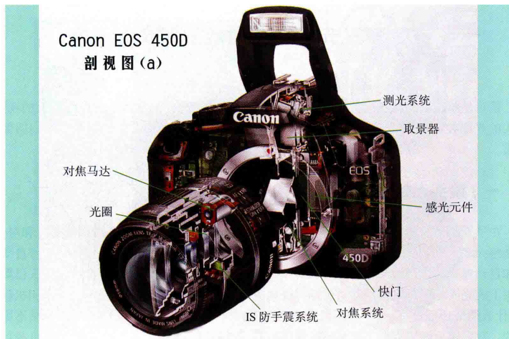
图1-3 数码单反相机正面剖视图
