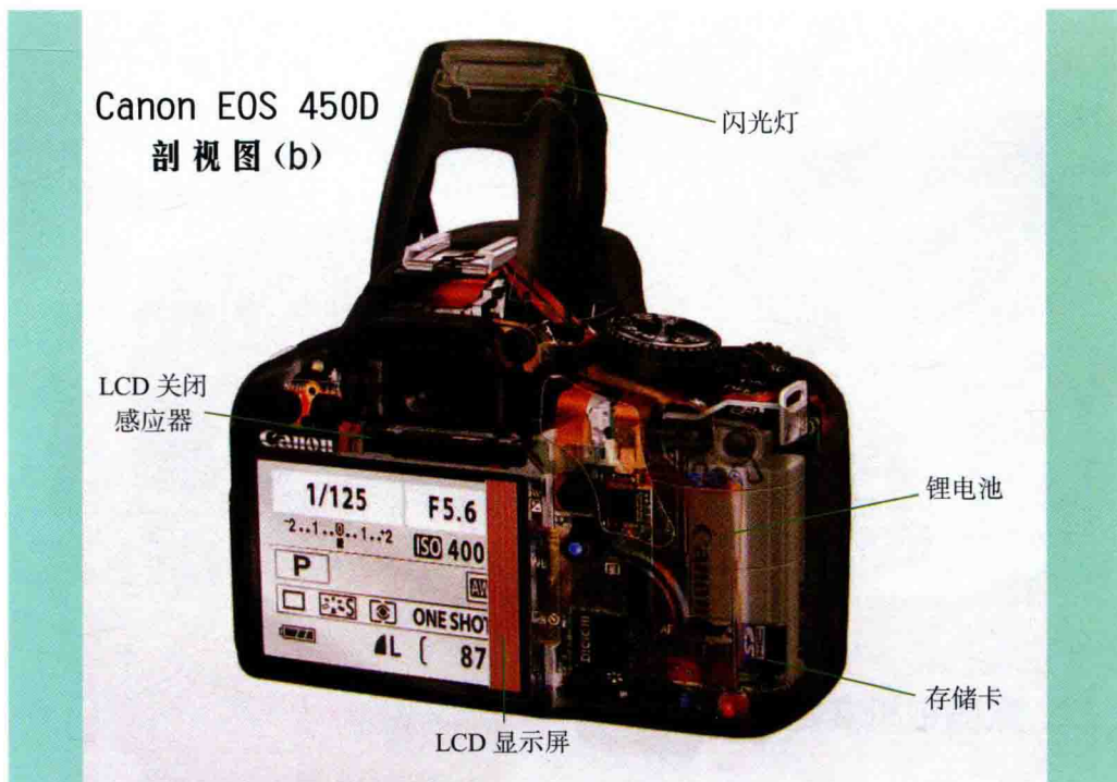
图1-4 数码单反相机背面剖视图
