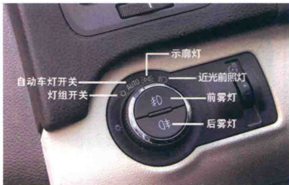
图 1-30 示廓灯开关的安装位置
