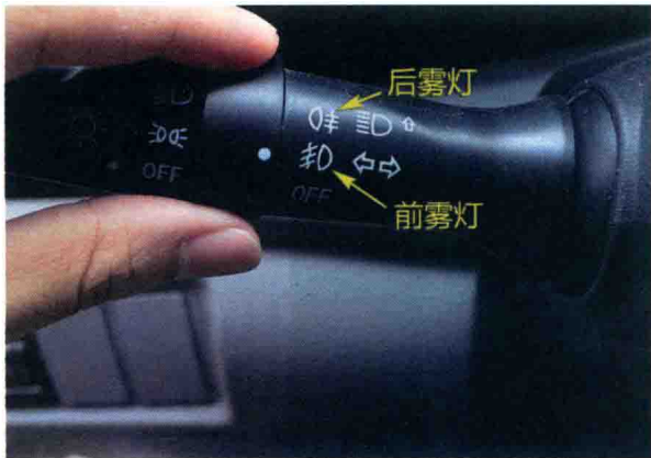
图 1-9 集成在左拨杆上的雾灯开关
