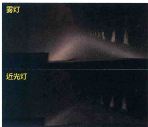
图 1-2 大雾天气下，雾灯和近光灯的透雾能力区别
