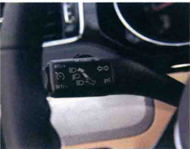
图 1-13 转向灯开关的开启方法
