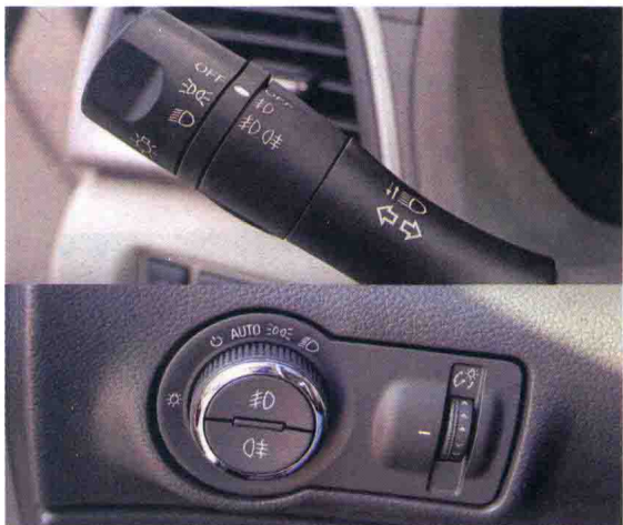
图 1-7 雾灯开关的安装位置
