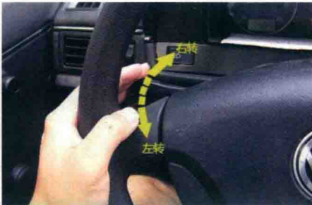
图 1-13 转向灯开关的开启方法
