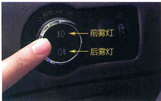
图 1-8 按键式雾灯开关的开启方法
