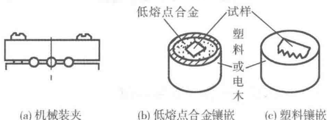
图 2-1 金相试样的镶嵌和装夹方法
