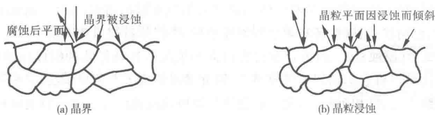
图 2-2 纯金属和单相金属浸蚀后的示意图
