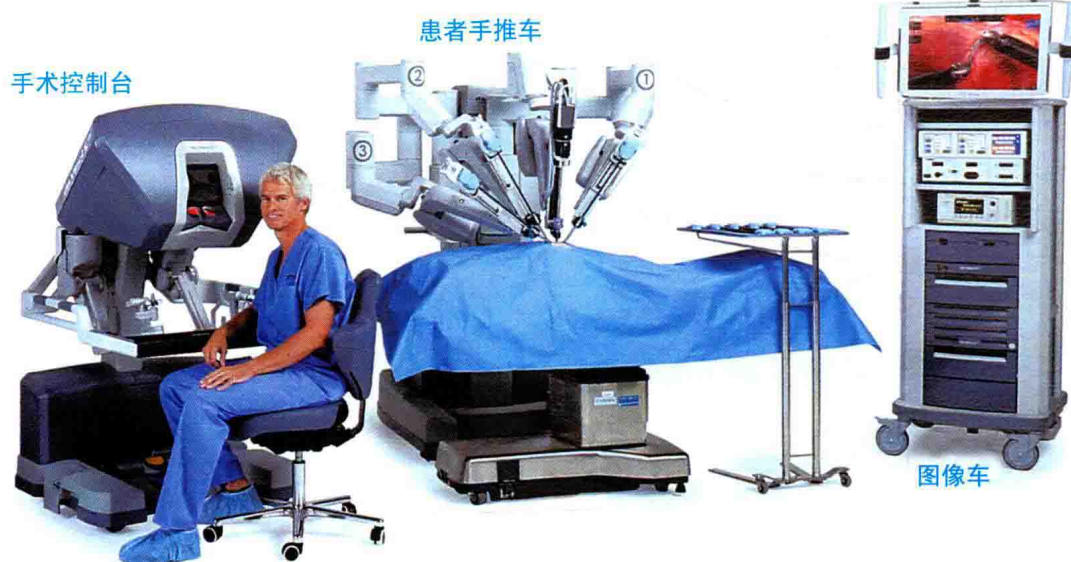
图 2.1.1 达·芬奇内窥镜手术器械控制系统主要组件
