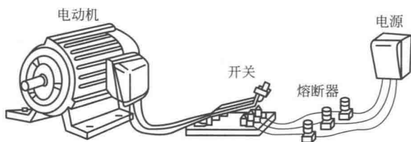
图 1-2 具有部分保护电器的电动机启停电路
