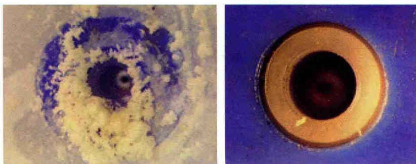
图 1.18 用于氯化钠水溶液 (左图) 和用于亲水性离子液体 (右图) 的喷嘴工作 10 h 后的状态 [334]
