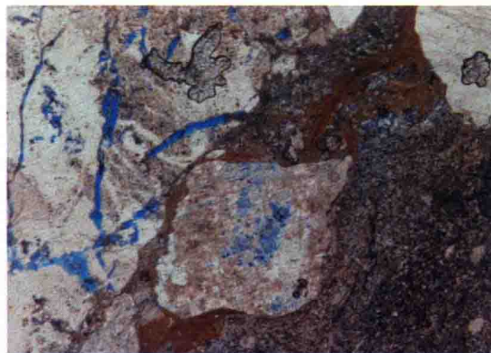
(d) 砂质砾岩, 以微裂缝和粒内溶孔为主 (T71740井, 1230.47m)
