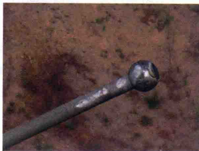
(b) 并联间隙球头烧蚀痕迹
