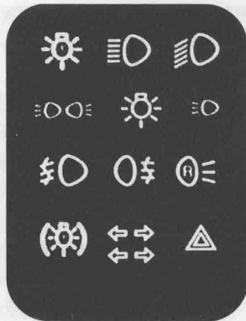
图 1-4 灯光监测装置的常用图例表（版权所有 嘉文·D.J. 哈珀）
