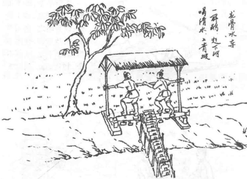
**龙骨水车** 灌溉农具，亦称翻车，又称踏车，历史悠久。车身用板作槽，槽中行道板一条，随槽阔狭，比槽板两头俱短一尺，用置大小轮轴，同行道板上下通。周以龙骨板系在大轴两端，各带拐木四茎，置岸上木架之间。入伏架上，有2人踏、4人踏、6人踏不等，以脚踏拐木，则龙骨板随转，循行道板刮水上岸，通过沟渠，引入水田，灌溉禾苗。今已不多见，为电力灌溉所代。
