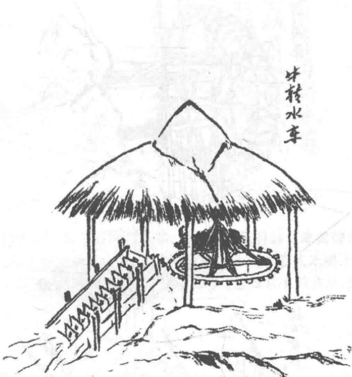
**牛转水车** 旧时灌溉农具，也叫牛转翻车，无锡人称牛打水。行制其本与龙骨水车同，但去下轮置于车旁，岸上用牛拉转轮轴，则翻车随转，循行道板刮水上岸，灌入沟渠，导入水田，功效远胜人力。车水的地点叫车口，一个车口所上的水，可灌五十亩稻田。一头牛可顶六个人力，一个车口要两头牛，更换上车，干一个班就是半天。为了不让牛看野眼，干活分心，故用二块竹片(俗称牛按眼)将牛眼遮住。曾流行于全国大部分地区，现已为电力灌溉所代。
