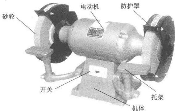
图 1.2 砂轮机构造
