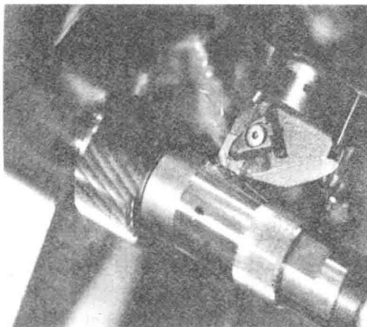
图 1.1 典型的车削加工
