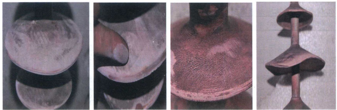
图 1-1 广东及广西地区抽样复合绝缘子伞裙粉化、发白、银纹等老化特征
