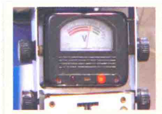
图 1-16 用高功率放电计测量蓄电池空载端电压
