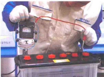
图 1-16 用高功率放电计测量蓄电池空载端电压
