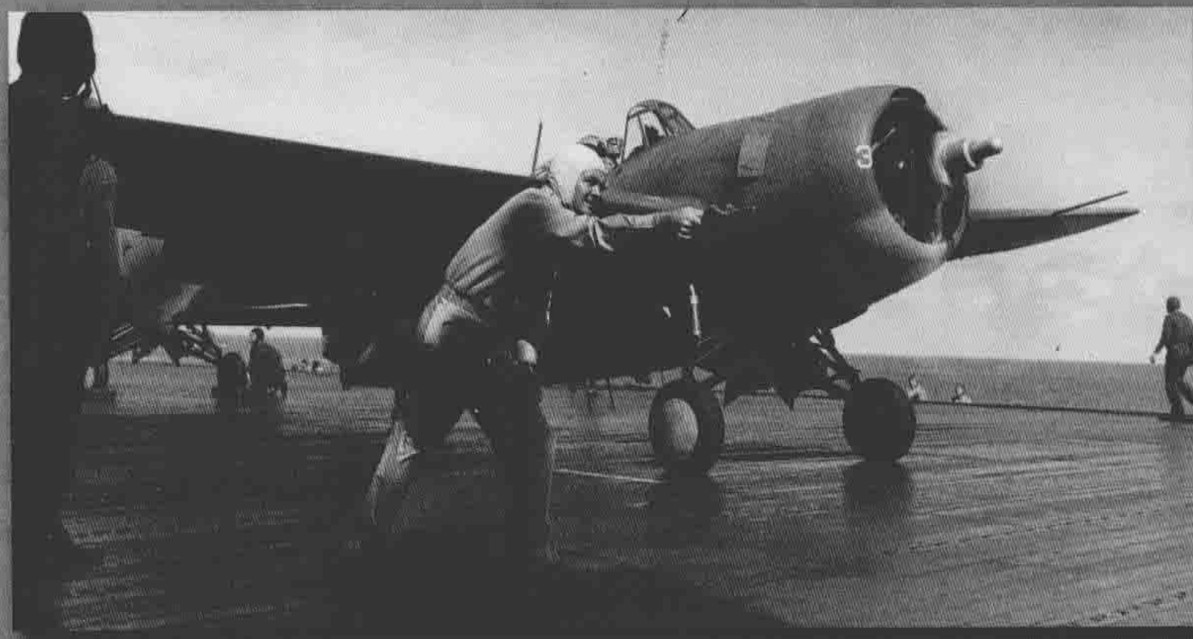
◀ 1942年初，美国海军VF-6飞行中队的一架F4F-3“野猫”战斗机准备从“企业（Enterprise）”号航母（CV-6）上起飞，注意其右翼下方挂有一枚100磅炸弹
