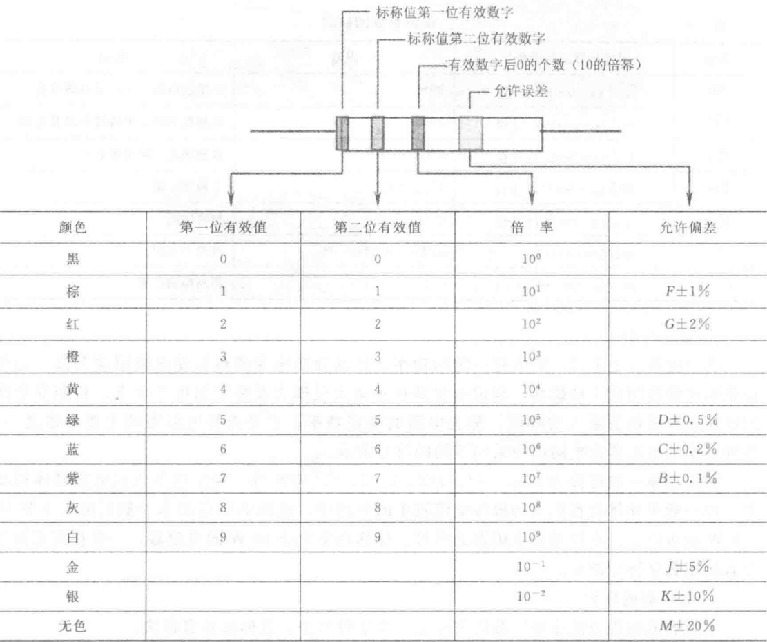
图 1-3 两位有效数字阻值的色环表示法
