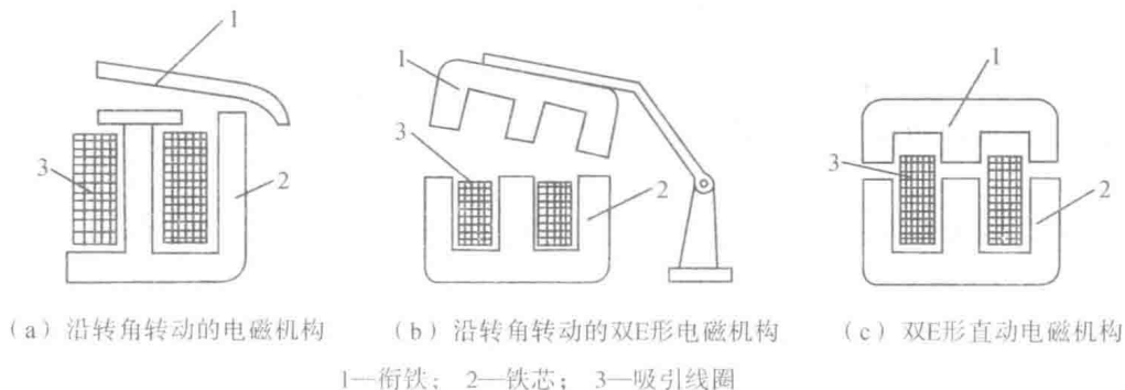
图 1-1 常用的磁路结构
