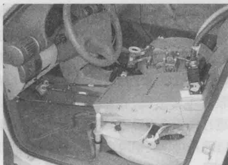
图 1.2 德国 STAHL 驾驶机器人
