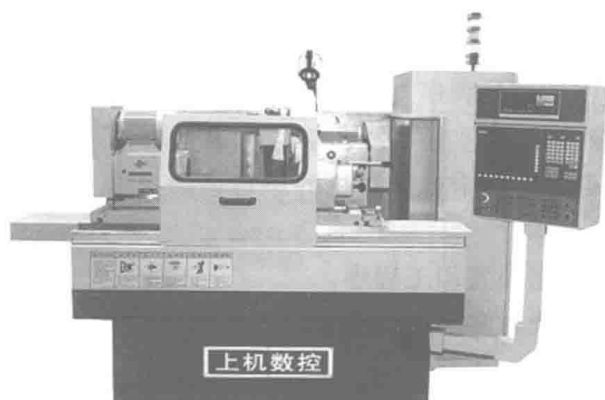
图 1-7 数控磨床(数控外圆磨床)
