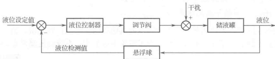
图 1-2 储液罐液位控制系统方框图
