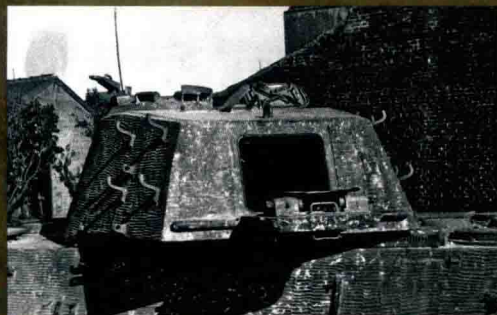
▲ 图示为虎II坦克的炮塔后部。该炮塔涂有“齐默尔特（Zimmerit）”防磁性雷涂层，但未安装指挥塔舱盖，沉重的炮塔后舱门上装有弹簧铰链
