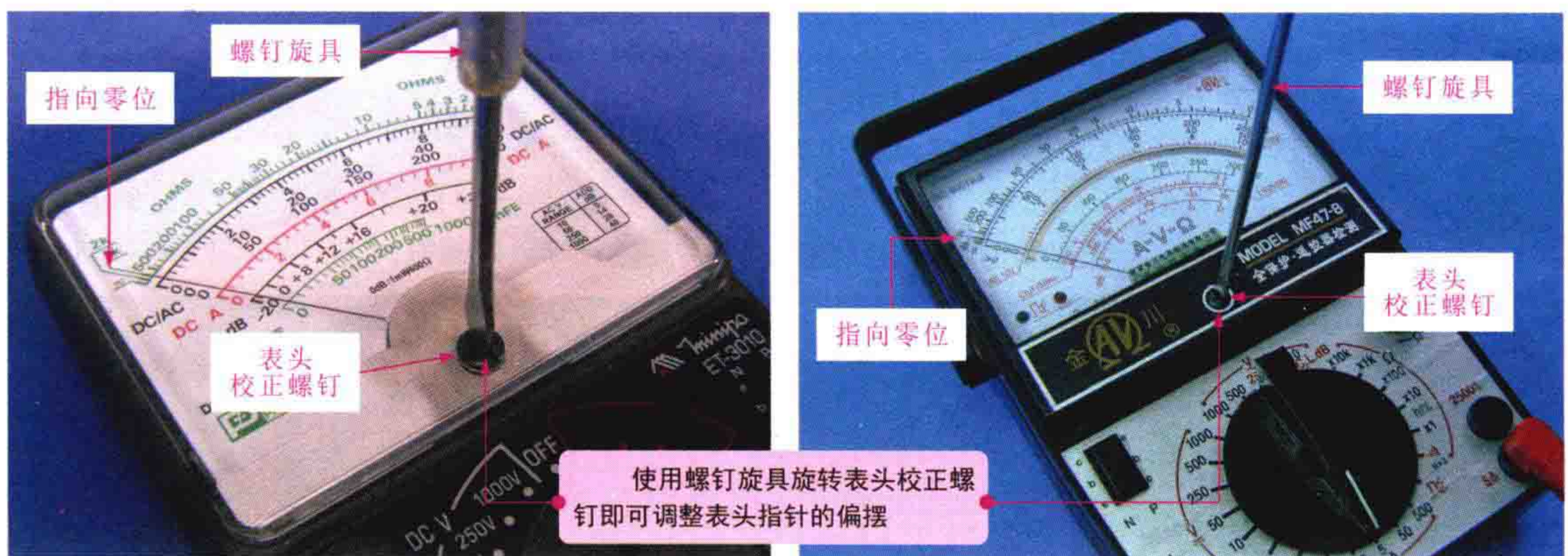
图 1-14 指针万用表的表头校正
