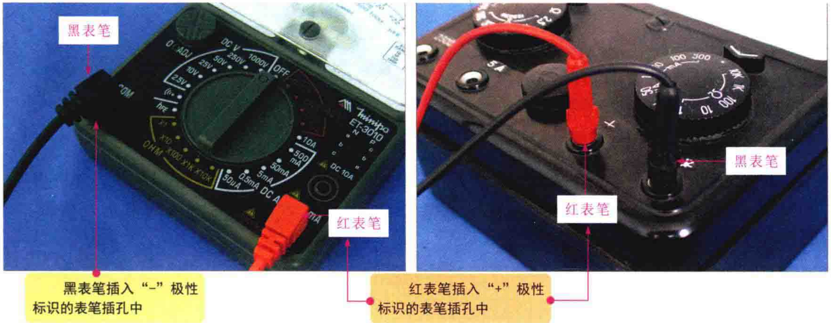
图 1-13 指针万用表测量表笔的连接操作
