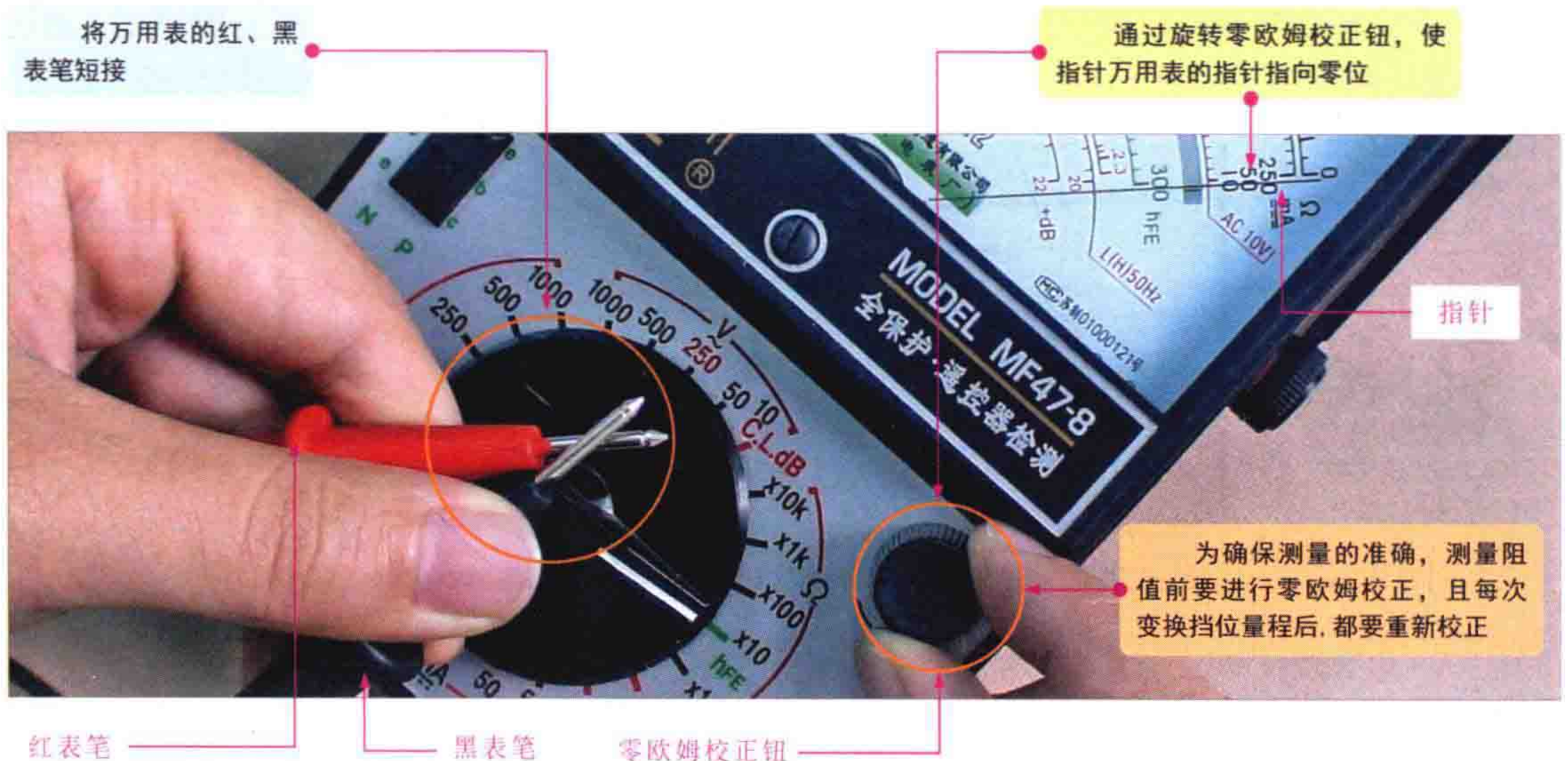
图 1-8 指针万用表零欧姆校正钮
