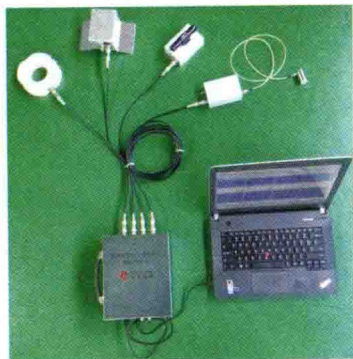
图 1-5 PD209 型特高频局放仪
