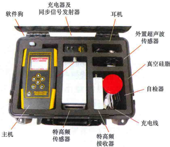
图 1-7 PDS-T90 型局部放电测试仪
