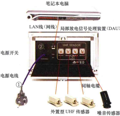
图 1-6 便携式 GIS 局部放电诊断装置
